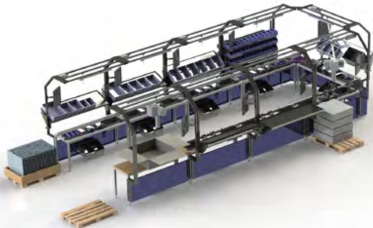
>> Die ZENTNER One-Piece-Flow Montagelinie ermöglicht die wirtschaftliche Montage von Baugruppen bis zu der Größe von 750x750x200mm.
